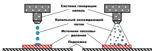
Рис.1. Схемы монодисперсного и конусного струйно-капельного охлаждения объектов
