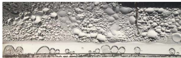
Рис. 10. Смена «прыгающего» кипения на обычный режим пузырькового кипения
