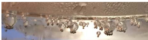
Рис. 3. Пузырьковое кипение в режиме «прыгающих» пузырей с участием свинцовых микросфер
