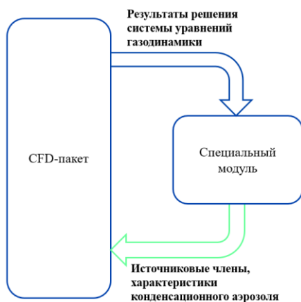
Рис. 1. Схема взаимодействия специального модуля и CFD-пакета.
