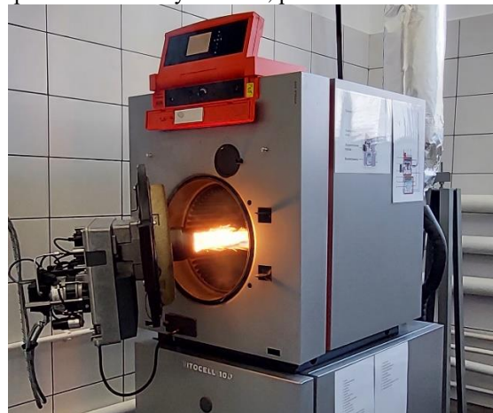
Рис. 4. Опытная установка для испытания жидкотопливных горелочных устройств на базе водогрейного котла Viessmann.
