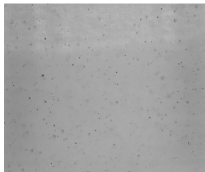
Рис. 4. Теневая фотография воздушно-капельного потока, полученная методом SSP
