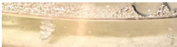
Рис. 4. Пузырьковое кипение в режиме «прыгающих» пузырями с участием микросфер из стекла
