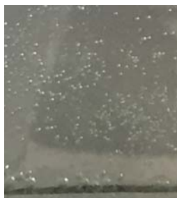
Рис. 9. Пузырьковое кипение дистиллированной воды с добавлением глицерина
