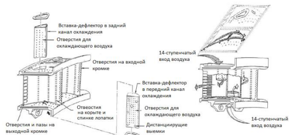
Рис.4. Сопловая лопатка 1-й ступени турбины высокого давления двигателя General Electric CF6-50 [4]
