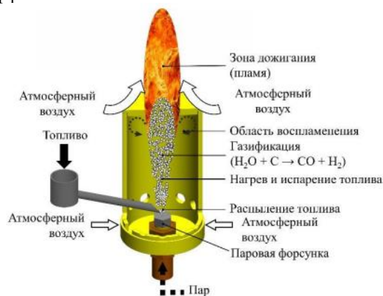
Рис. 1. Схема атмосферного горелочного устройства с распылением жидкого топлива струей перегретого водяного пара с естественным притоком воздуха.
