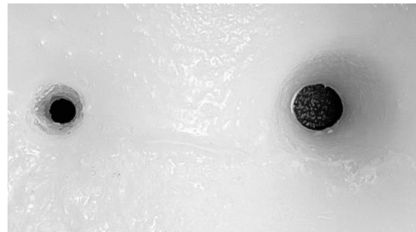
Рис.1. Отверстия в парафине, полученные от перегретой струи воды без закрутки (слева) и с закруткой 10 об/сек (справа). Наименьший диаметр для отверстия слева – 3 мм, для другого – 5 мм.
