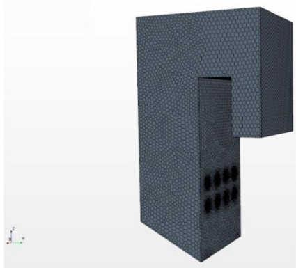
Рис. 1. Геометрия котла с сеткой.
