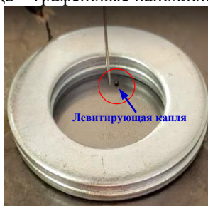
Рис.7. Левитирующая капля воды на поверхности графеновыми нанохлопьями
