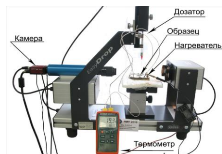
Рис.2. Схема установки для исследования смачивания, растекания, испарения и кипения
