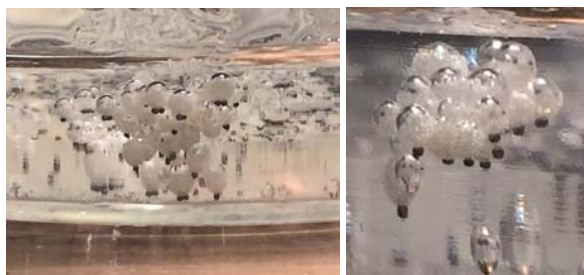
Рис. 5. Пузырьковое кипение в режиме «прыгающих» пузырей с участием свинцовых и стеклянных микросфер
