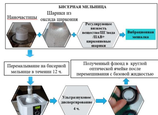
Рис. 1. Этапы приготовления нанохладоносителя
