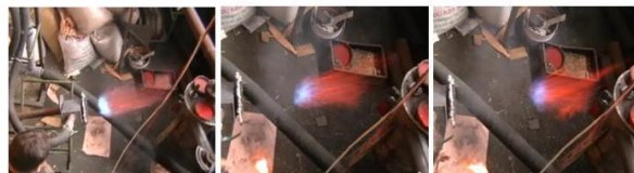
Рис. 3. Крайние режимы поддержания горящего факела в пространстве за горелкой и начало размывание горящего факела при сильном СРВ
