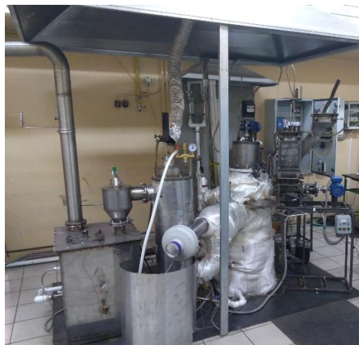
Рисунок 1. Установка по переработки отходов Представленная экспериментальная установка обладает максимальной пропускной способностью 6 кг/ч.
