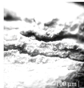
Рис. 1. Покрытие на основе наночастиц оксида алюминия с микротраншеями.
