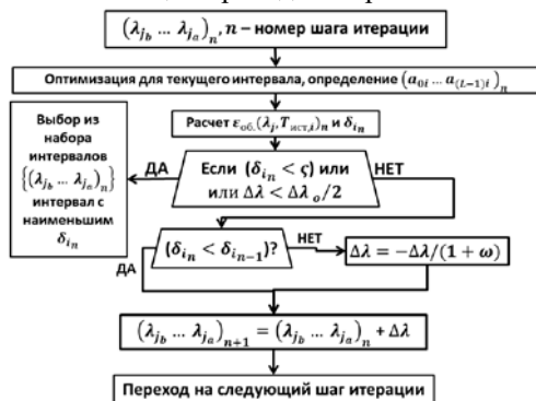
Рис.3. Схема алгоритма оптимизации положения спектрального интервала для определения истинной температуры поверхности
