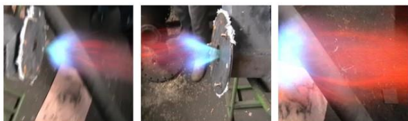
Рис. 2 Втягивание осевой зоны факела в горелку
