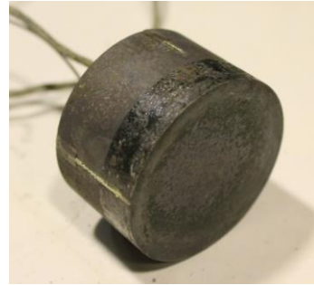
Рис. 1. Цилиндр со стеклокерамическим покрытием после проведения тепловых испытаний
