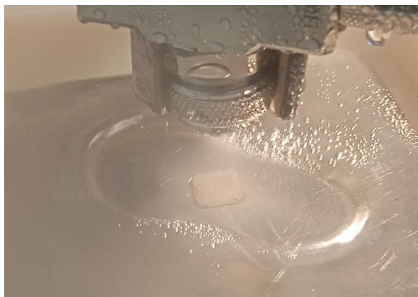
Рис. 2. Фото процесса газоспрейного охлаждения при подаваемой мощности 800 Вт. Расход газа 15 л/мин, воды 150 мл/мин.
